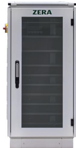
MTS310 U: 3 x 500 VA I: 3 x 600 VA Class 0.02 up to 0.005
