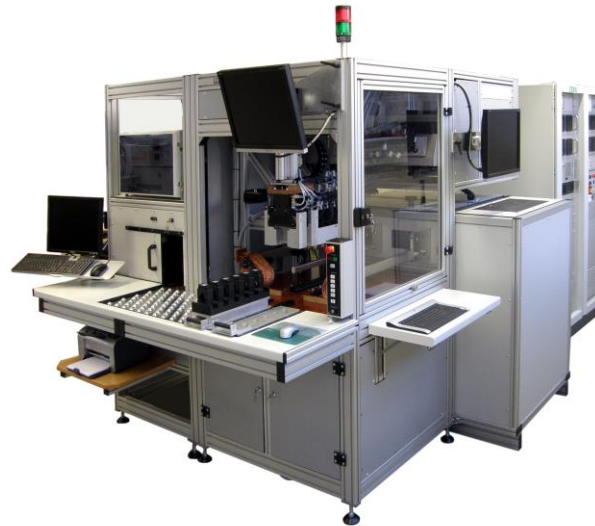
ITTS (CT, 32 kVA) CT-Prüfsystem Erzeugung: 32 kVA
