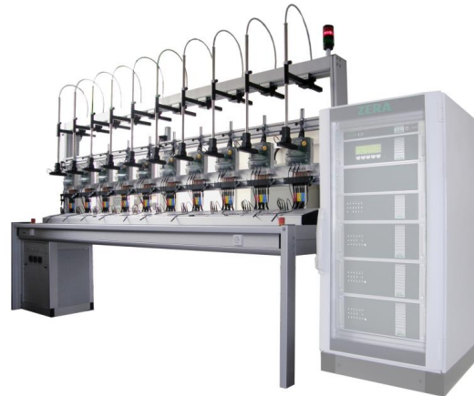
Mehrplatz-Prüfstand 5, 10, 20 oder 40 Messplätze verschiedene Ausführungen
