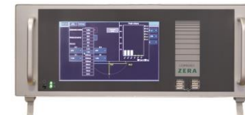
COM5003 Komparator/Prüfzähler Klasse 0.005
